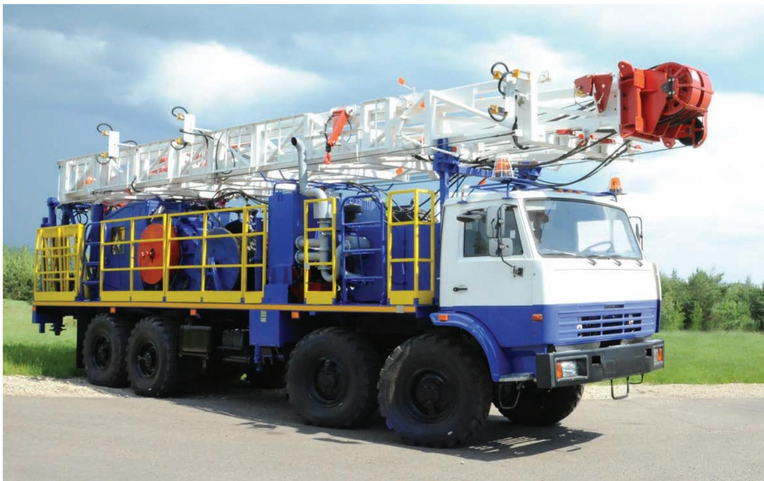
Агрегат «АПРС–40С4» предназначен для бурения роторным способом с прямой промывкой забоя в породах мягкой и средней твердости структурно-поисковых скважин, гидрогеологических и эксплуатационных скважин на воду, а также для ремонта скважин при которых максимальные нагрузки не будут превышать параметра «Допускаемая нагрузка на крюке» в соответствии с его грузоподъемностью.
