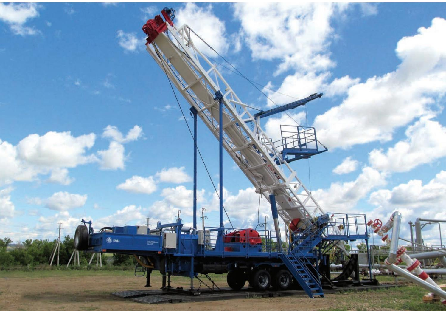
Агрегат предназначен для проведения подземного ремонта скважин с расположением устья под углом 45°- 75° относительно поверхности земли, в том числе для выполнения спускоподъемных операций с глубинно-насосными штангами Ø22, 25 мм и насосно-компрессорными трубами (НКТ) Ø48, 60, 73, 89 мм, механизированного свинчивания-развинчивания штанг и труб с применением гидравлического ключа, монтажа-демонтажа фонтанной арматуры и противовыбросового оборудования.
