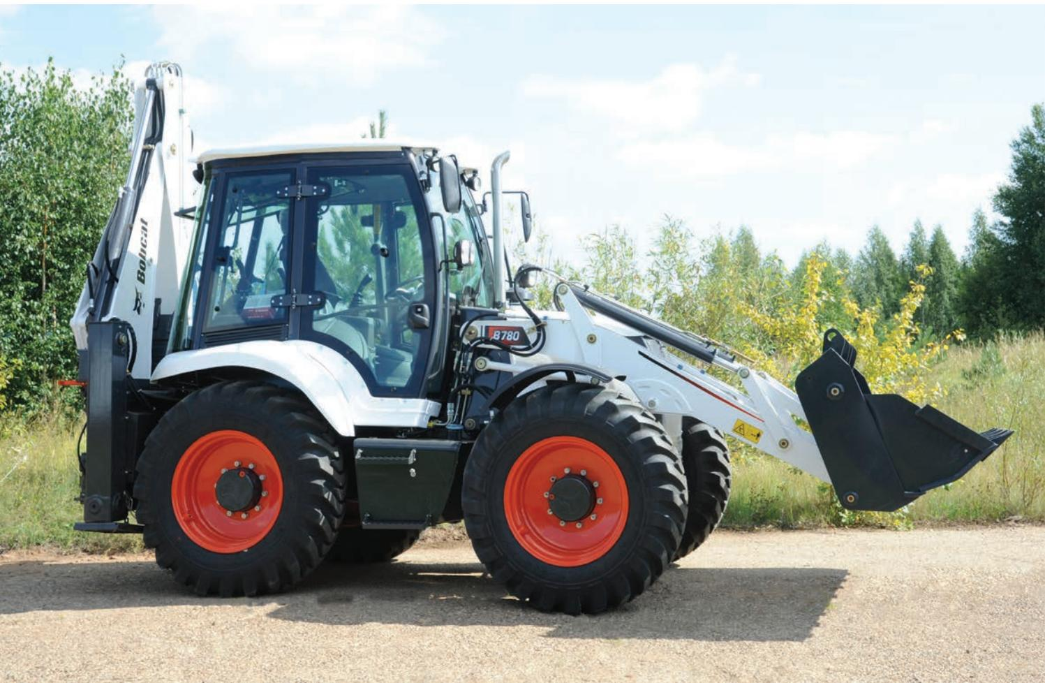
Универсальность экскаватора-погрузчика BOBCAT B-780 повышается за счет возможности использования многочисленного дополнительного оборудования (телескопическая рукоять, гидравлический молот, дополнительные ковши различных размеров, грейфер и др.), применяемое в дорожно-строительном и коммунальном хозяйстве. Надежность конструкции и эффективность гидравлической системы экскаватора обеспечивает значительное усилие отрыва и копания задней обратной лопатой.
