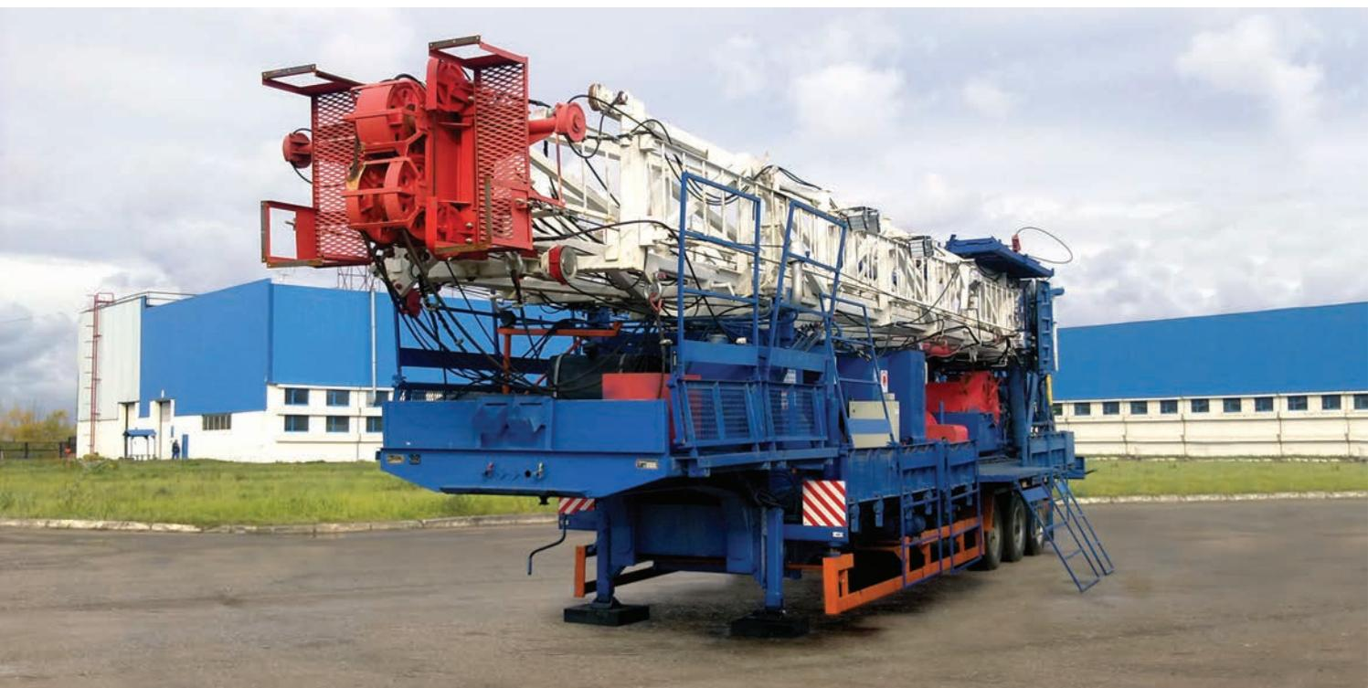
Предназначена для бурения ротором и забойными двигателями скважин глубиной 2500м (при массе колонны 24 кг/м), капитальных ремонтов, освоения и восстановления нефтяных и газовых скважин, глубиной до 5000 м. (НКТ 14кг/м) в макроклиматических районах с умеренным климатом при температуре окружающего воздуха от -45° С до +40° С.
