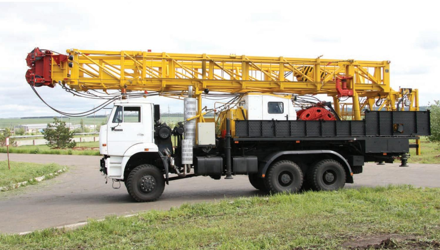
Агрегат предназначен для капитального ремонта и освоения нефтяных и газовых скважин в макроклиматических районах с умеренным климатом при температуре окружающего воздуха от  $-45^{\circ}\text{C}$  до  $+40^{\circ}\text{C}$ .
