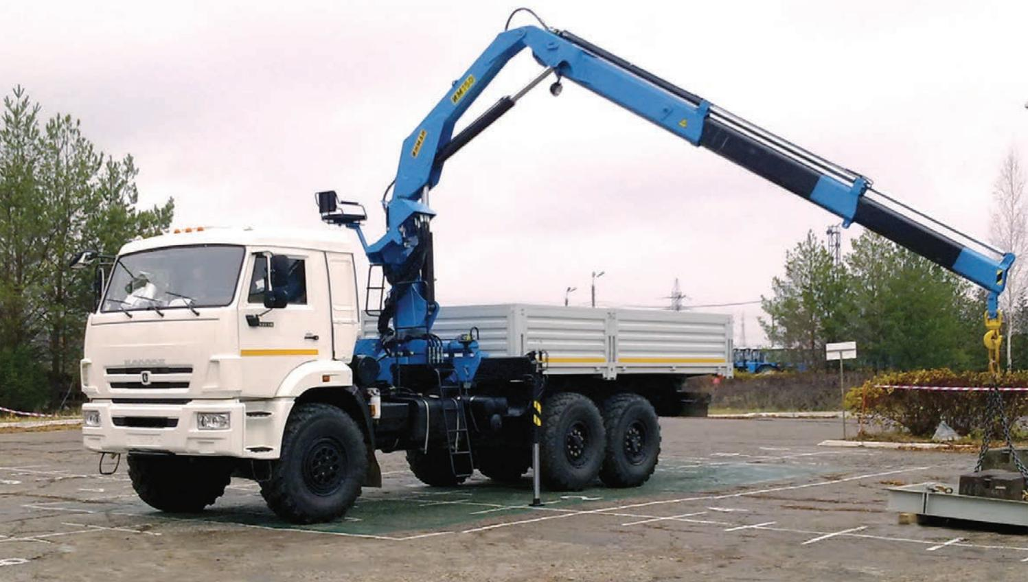
Высокопроизводительные краны манипуляторы КМА-Е различной грузоподъемности предназначены для транспортировки грузов, выполнения погрузочно-разгрузочных и монтажных работ, эвакуации автотранспортных средств.
