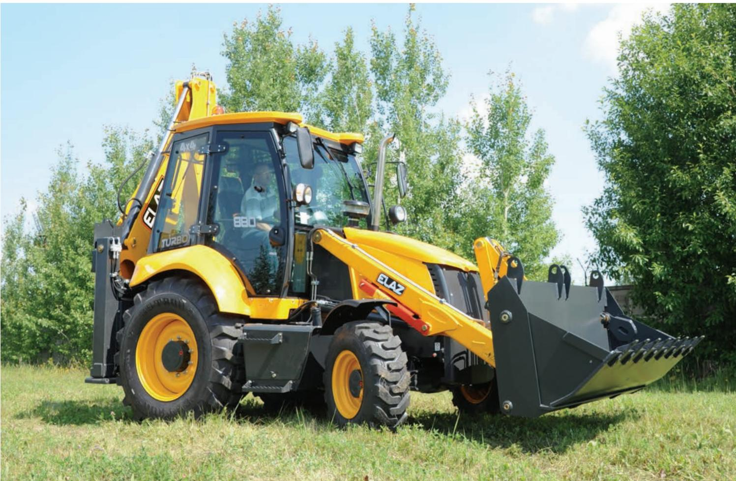
Экскаваторы-погрузчики ELAZ-BL 880 — это универсальная дорожно-строительная техника, которая идеально объединяет в себе функции ковшового экскаватора и фронтального погрузчика. ELAZ-BL 880 относится к машинам нового поколения, в которых реализовано оптимальное распределение веса, благодаря чему обеспечивается безопасное, устойчивое вождение по шоссейным дорогам и твердая основа для копания.
