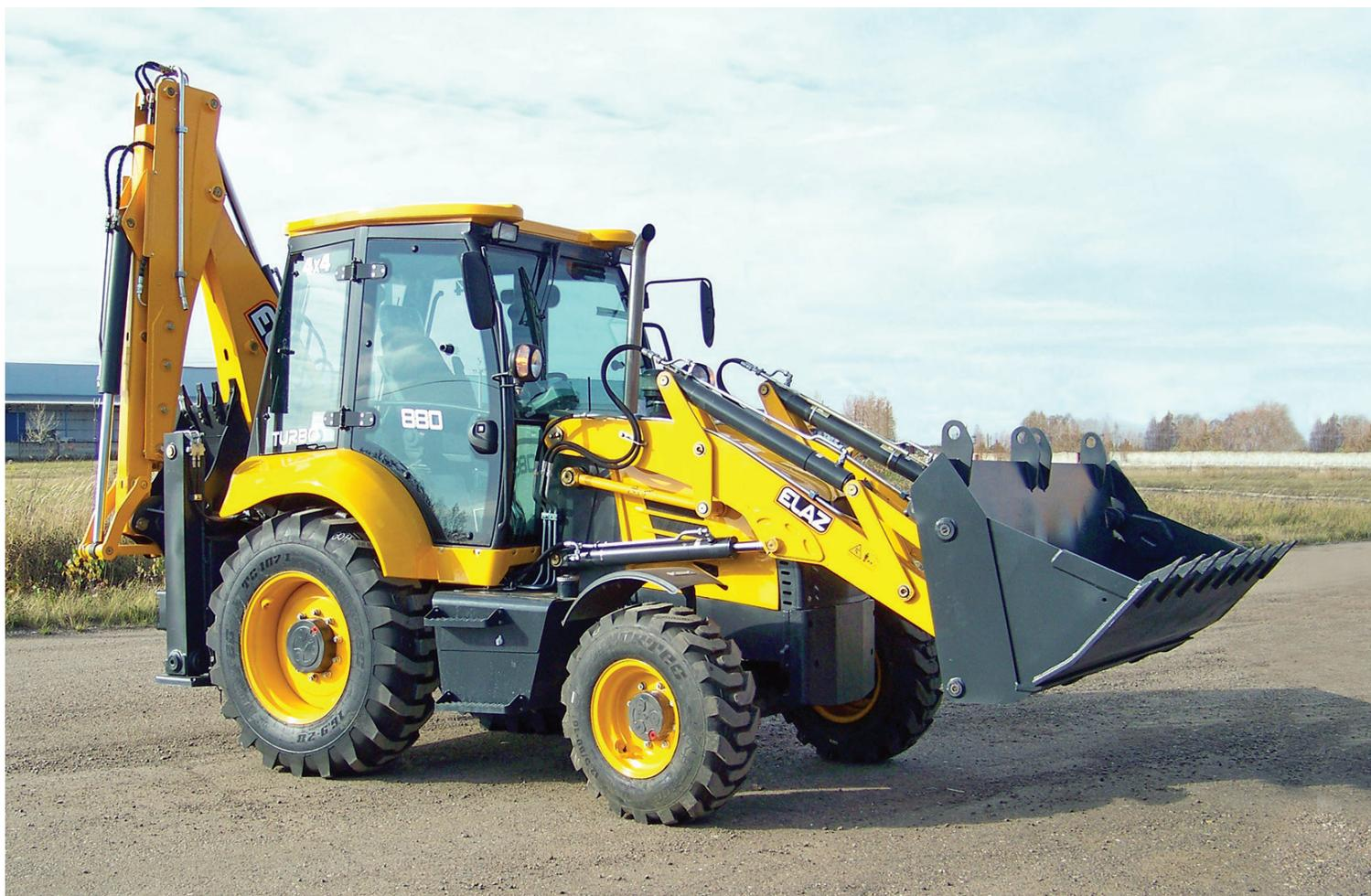
ELAZ-BL 880 относится к машинам нового поколения, в которых реализовано оптимальное распределение веса, благодаря чему обеспечивается безопасное, устойчивое вождение по шоссе и твердая основа для копания. Конструкция экскаватора-погрузчика ELAZ-BL 880 позволяет устанавливать различное навесное оборудование, применяемое в дорожно-строительном и коммунальном хозяйстве.
