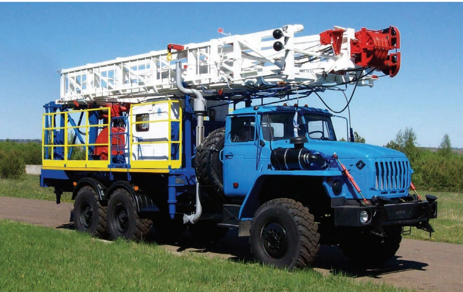
Агрегат предназначен для подземного ремонта и освоения нефтяных и газовых скважин в макроклиматических районах с умеренным климатом при температуре окружающего воздуха от  $-45^{\circ}\text{C}$  до  $+40^{\circ}\text{C}$ .
