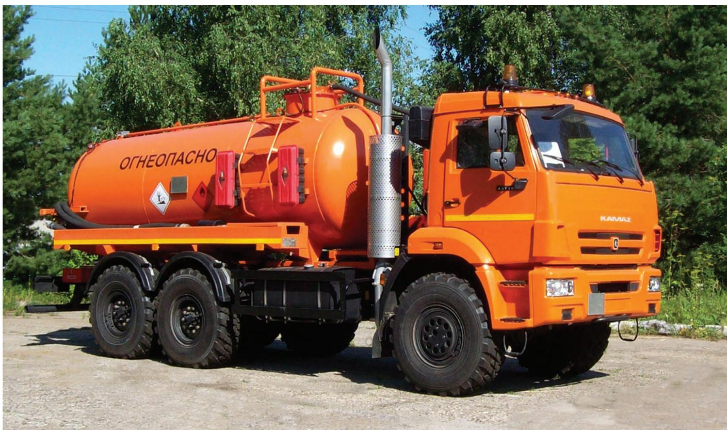
Предназначен для сбора разлитой нефти, газового конденсата, нефтепродуктов и неагрессивных технологических жидкостей, а также для их транспортировки к местам утилизации и переработки.
