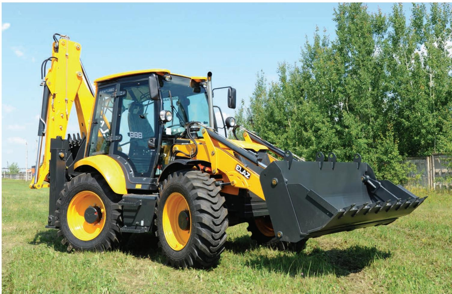
Экскаватор-погрузчик ELAZ-BL 888 универсальная дорожно-строительная техника, которая идеально объединяет в себе функции ковшового экскаватора и фронтального погрузчика.
