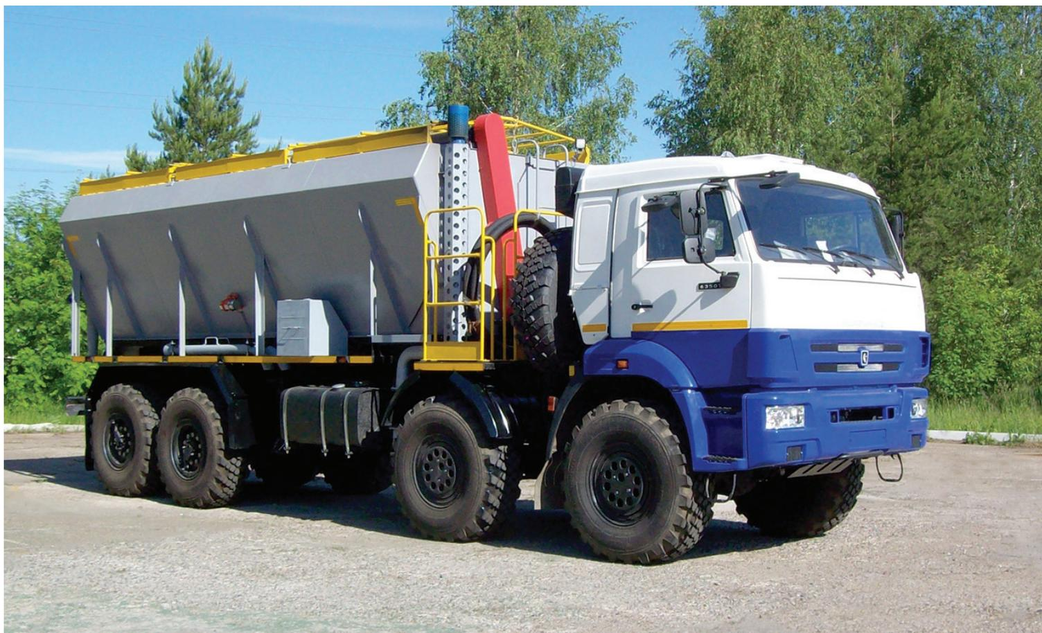
Предназначена для транспортирования сухих порошкообразных материалов (цемент, тампонажные смеси и др.), для механической регулируемой подачи этих материалов винтовыми конвейерами (шнеками) и приготовления тампонажных растворов при цементировании нефтяных и газовых скважин.
