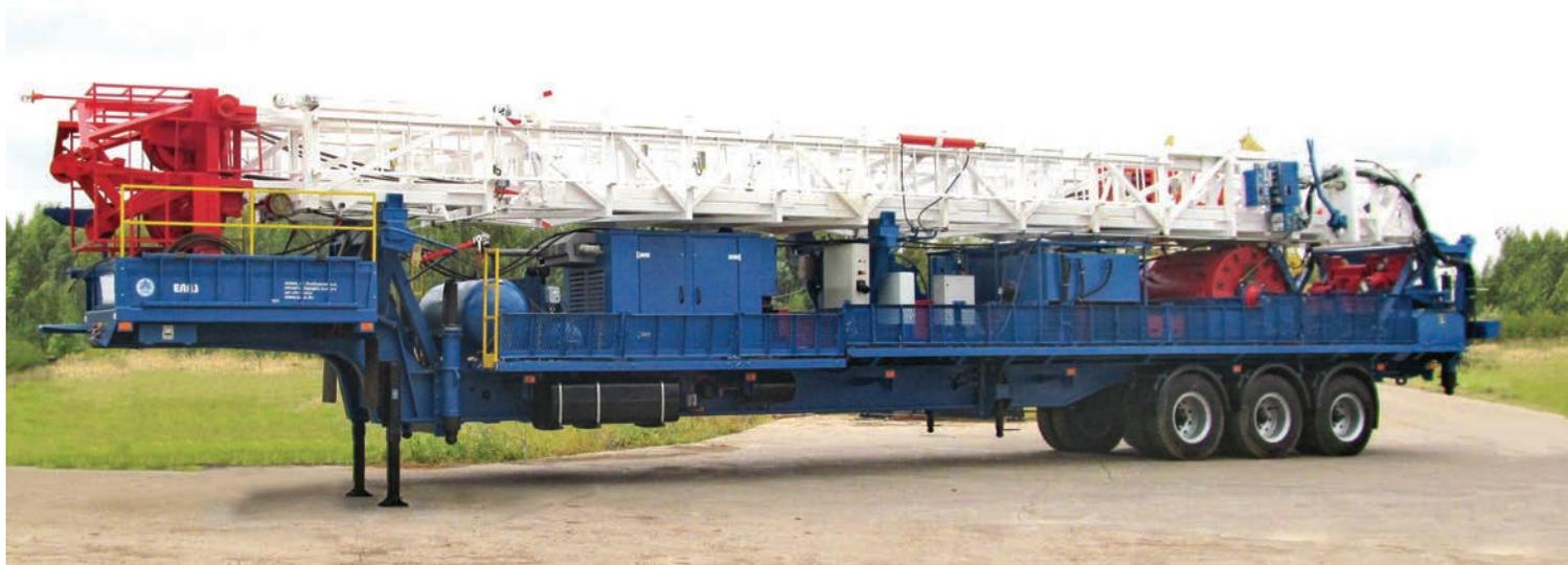
Установка предназначена для освоения и капитально-го ремонта нефтяных скважин, а также ведения буровых работ роторным способом или забойными двигателями скважин различного назначения: поисковых, гидрогеологических, водозаборных, эксплуатационных (нефтяных, газовых.) в районах с умеренным и холодным климатом при температуре окружающего воздуха от  $-45^{\circ}\text{C}$  до  $+40^{\circ}\text{C}$ , категория размещения 1 по ГОСТ 151510.
