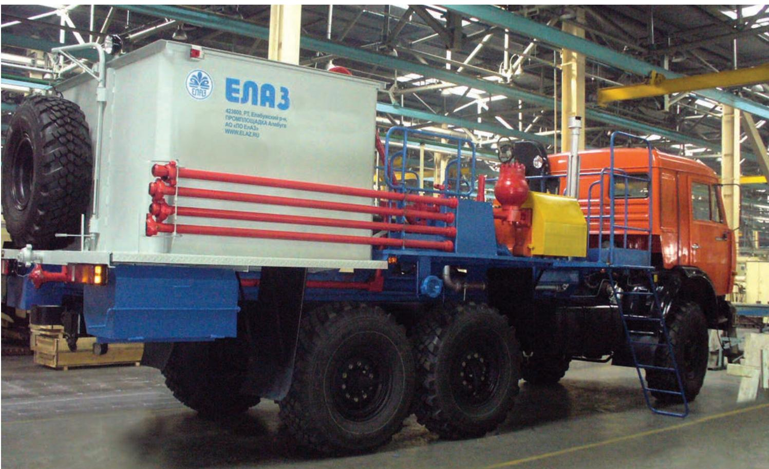
Предназначен для нагнетания жидких сред при цементировочных, промывочно-продавочных работах в процессе бурения, освоения и капитального ремонта скважин.
