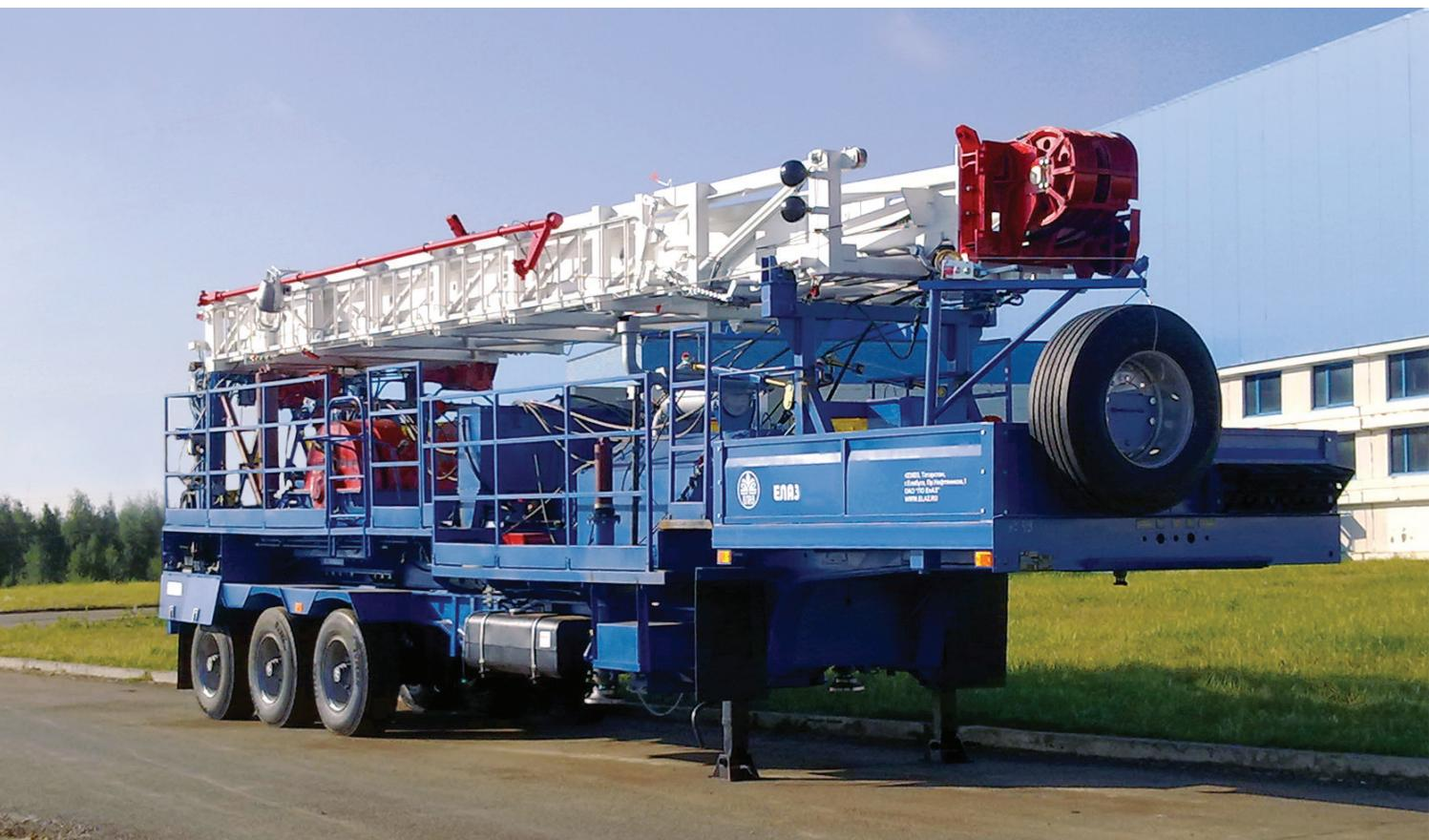
Агрегат предназначен для освоения, капитального и подземного ремонта нефтяных и газовых скважин в макроклиматических районах с умеренным климатом при температуре окружающего воздуха от  $-45^{\circ}\text{C}$  до  $+40^{\circ}\text{C}$ .
