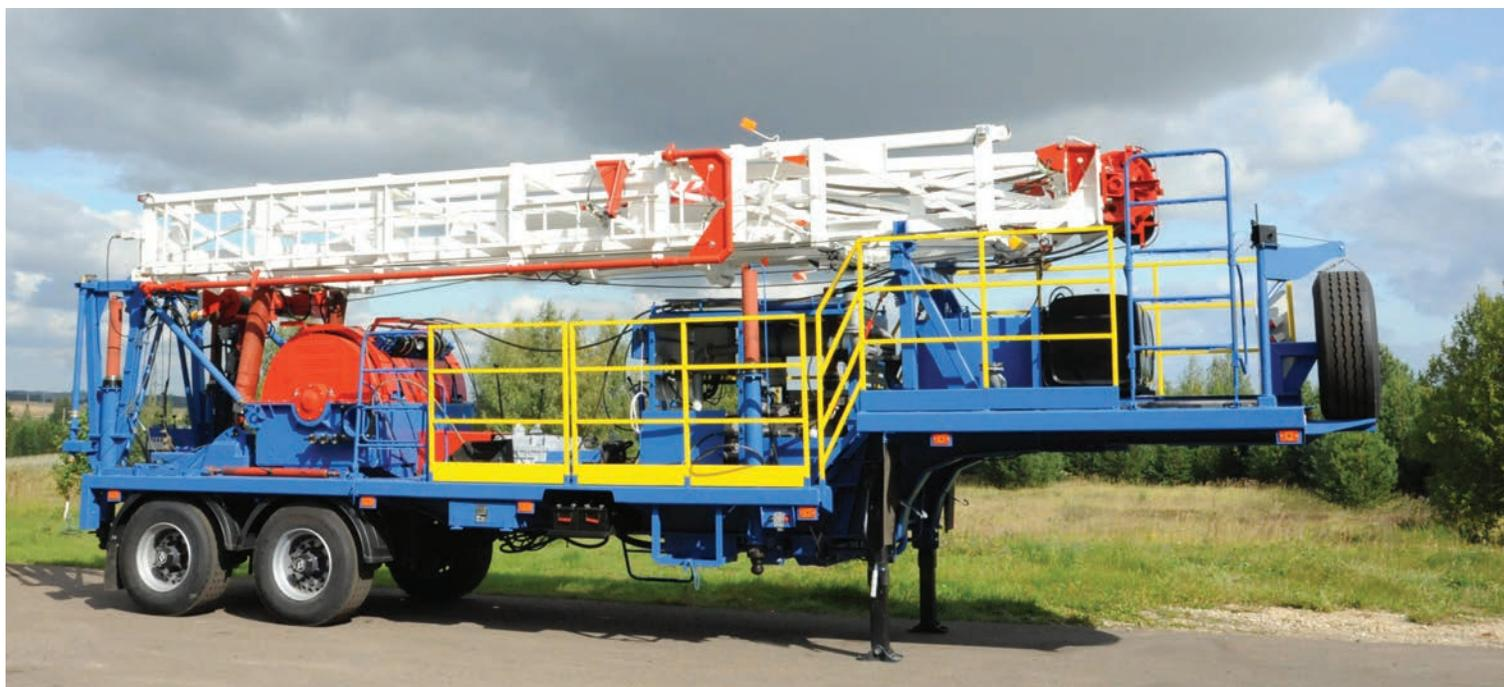
Агрегат АПРС-32/40 предназначен для подземного ремонта и освоения нефтяных и газовых скважин в макроклиматических районах с умеренным климатом при температуре окружающего воздуха от -45°C до +40°C.
