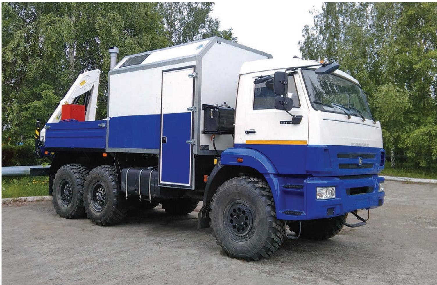
Позволяет производить сварочные, газорезательные, монтажные, монтажно-демонтажные, слесарные работы, покраску оборудования и сооружений; при наличии быстросъемной люльки окраску и ремонт оборудования до 12 м; транспортировку различного оборудования, перевозку дежурной бригады в количестве до 5 человек.
