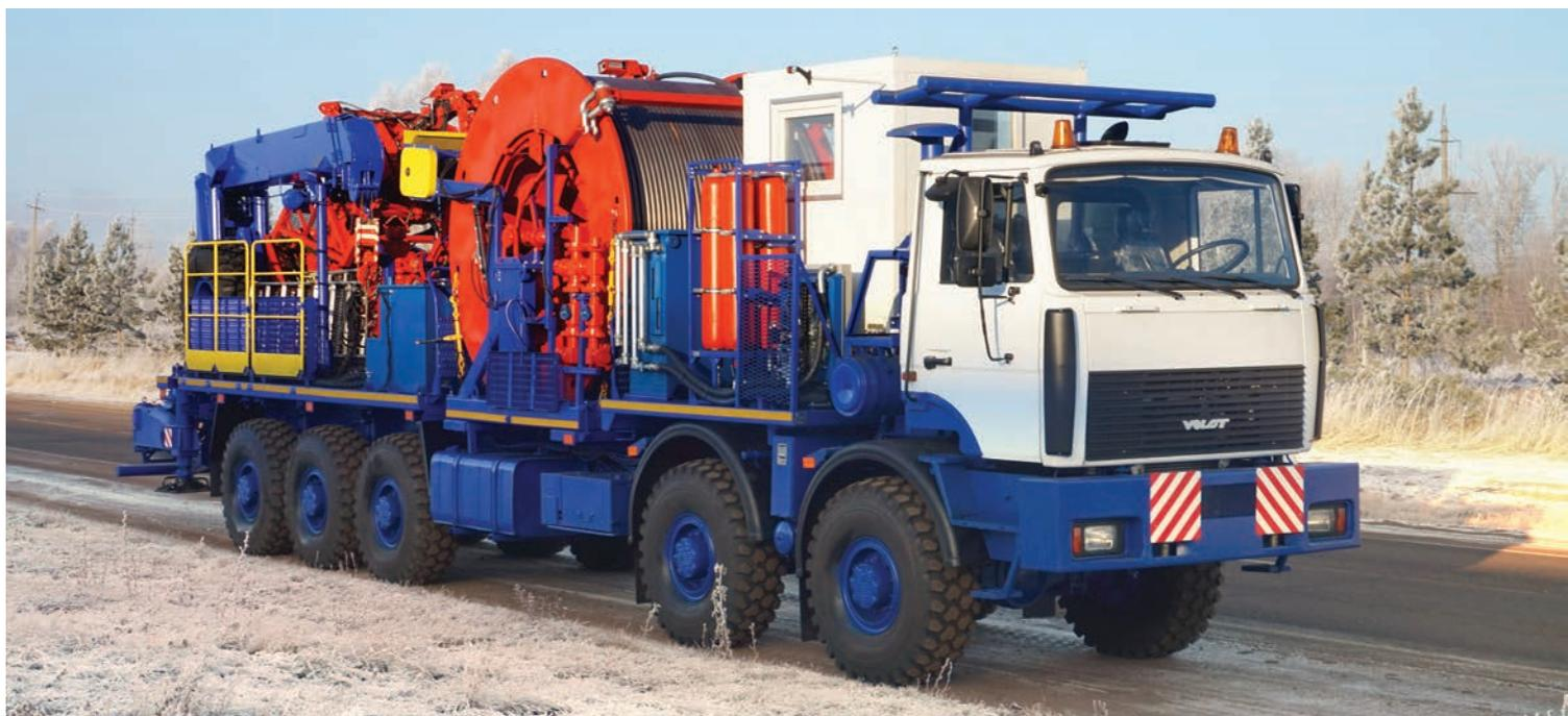
Установка колтюбинговая РКУ25 предназначена для проведения спуско-подъемных и технологических операций с использованием БДТ при капитальном, текущем ремонте и интенсификации нефтяных и газовых скважин (ликвидации гид-ратных, парафинистых, песчаных отложений и пробок, кислотной обработки приза-бойной зоны и так далее), без их глушения при давлении на герметизируемом устье до 70 МПа.
