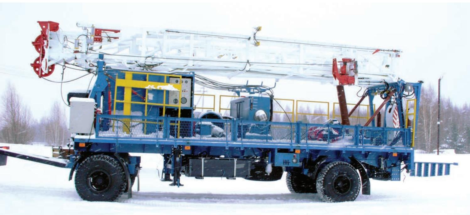
Агрегат подъемный для ремонта скважин АПРС-12 (в дальнейшем – агрегат), предназначен для проведения текущего ремонта скважин, с возможностью регулировки и центровки мачты, спуска-подъема УЭЦН (установка погружных центробежных насосов), штанговых винтовых насосов.
