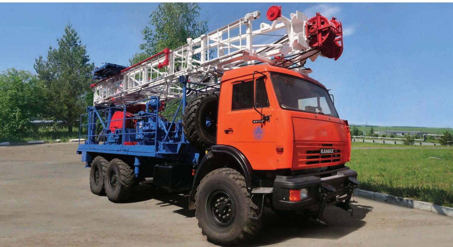
Установка УРБ-30 предназначена для структурно-поискового бурения на нефть и газ роторным способом в породах мягкой и средней твердости с прямой промывкой, а также бурения скважин на воду в макроклиматических районах с умеренным климатом при температуре окружающего воздуха от  $-45^{\circ}\text{C}$  до  $+40^{\circ}\text{C}$ .
