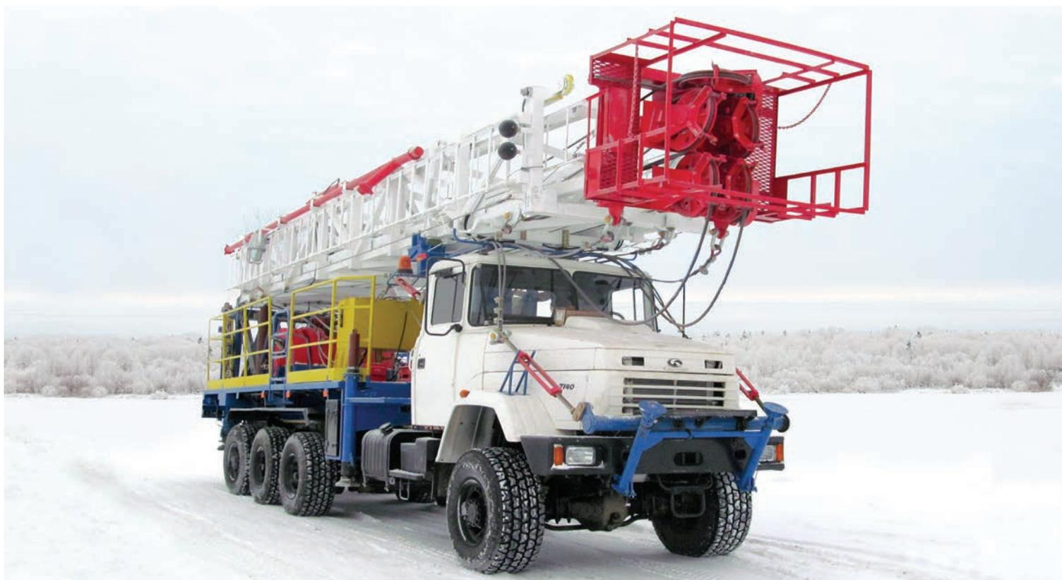
Установка подъемная передвижная «УПР-100» предназначена для проведения капитального ремонта, бурения и освоения глубоких скважин, в условиях умеренного и холодного (район 12) макроклиматических районов по ГОСТ 16350 с температурой окружающей среды от  $-45^{\circ}\text{C}$  до  $+40^{\circ}\text{C}$ .
