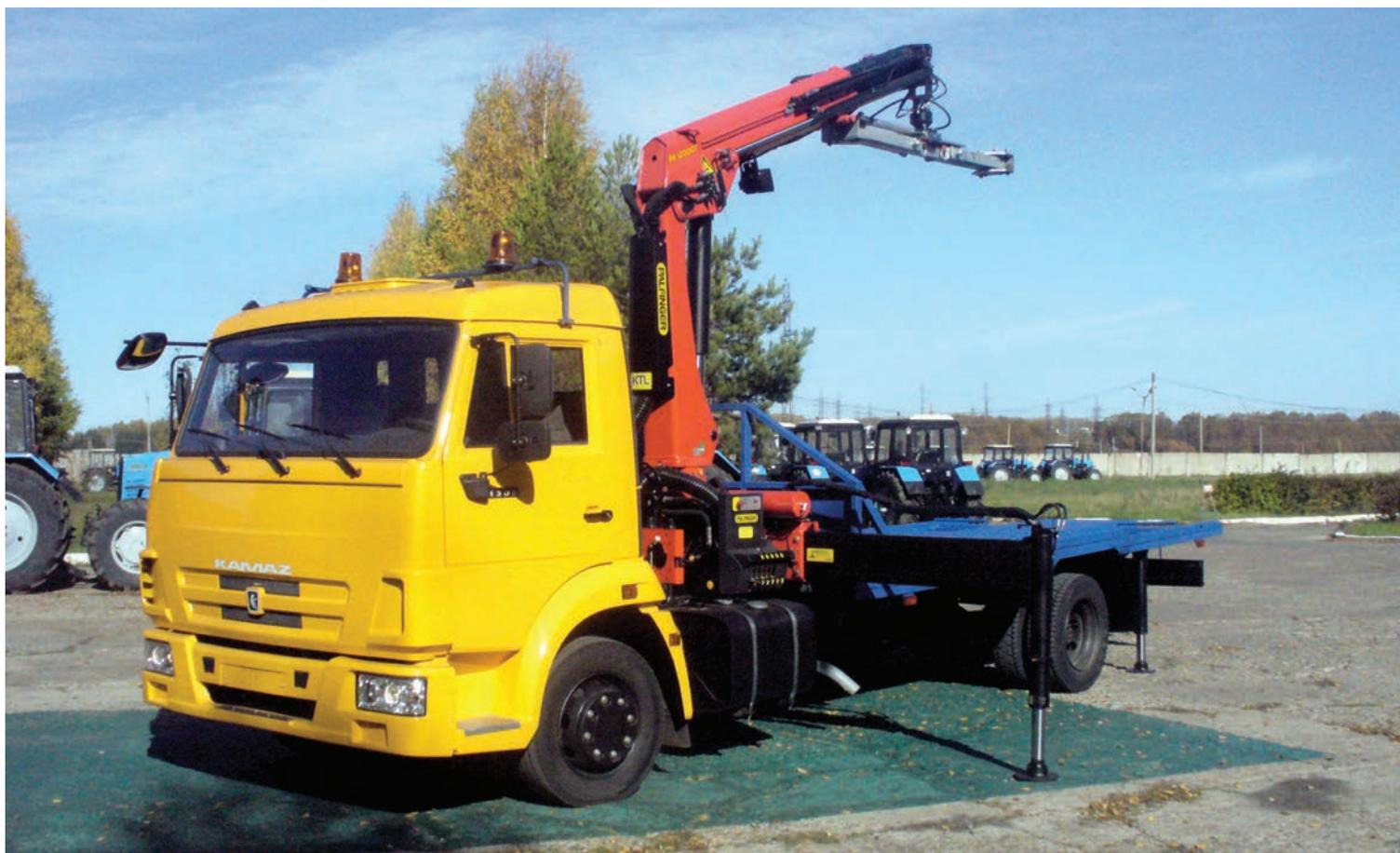
Автомобиль аварийно-технической службы (эвакуатор) предназначен для перевозки автотранспортных средств массой до 3,2 т.
