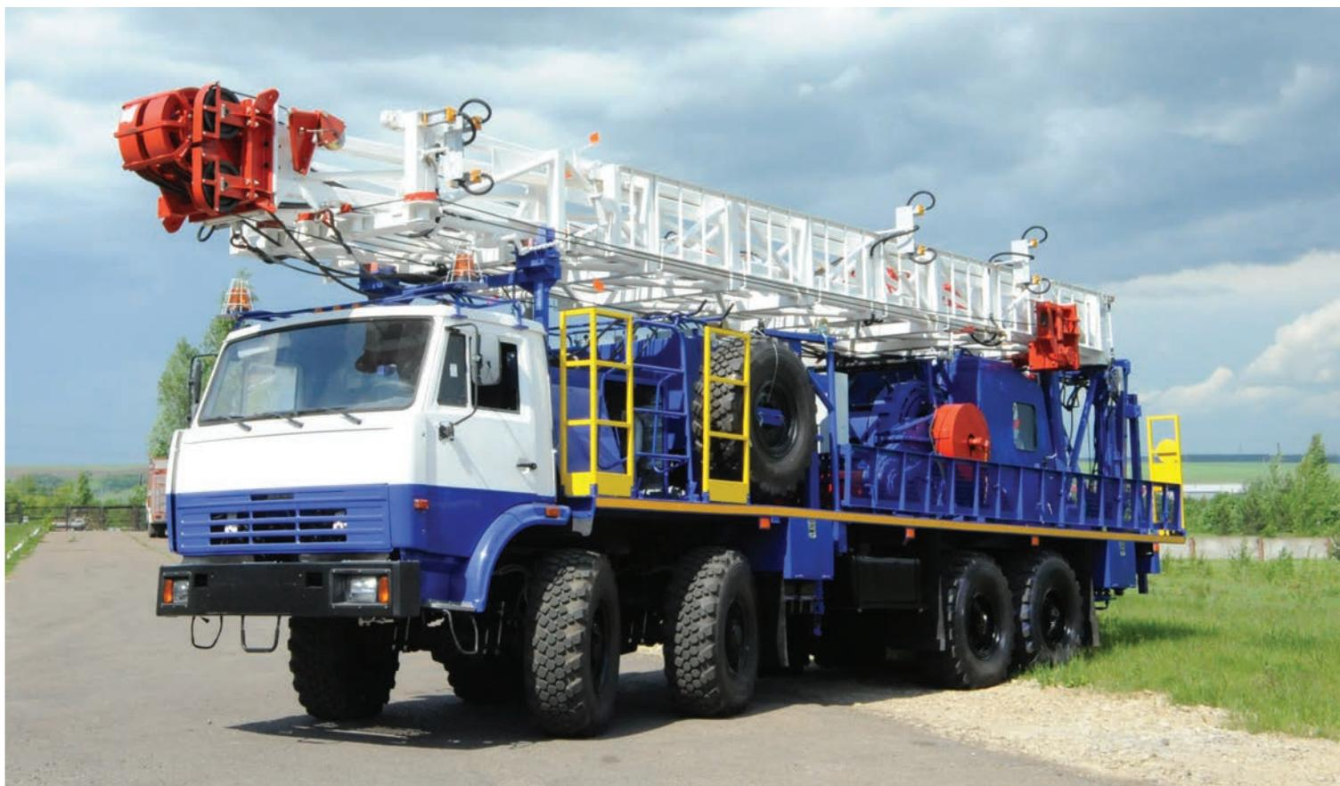
Агрегат «АПРС-50С» предназначен для ремонта и освоения нефтяных и газовых скважин (ПРС, КРС и ОС) с такими глубинами, при которых максимальные нагрузки, в том числе при ликвидации аварий (прихватов), ожидаемые в процессе ремонта, не будут превышать параметра «Допускаемая нагрузка на крюке» в соответствии с его грузоподъемностью.
