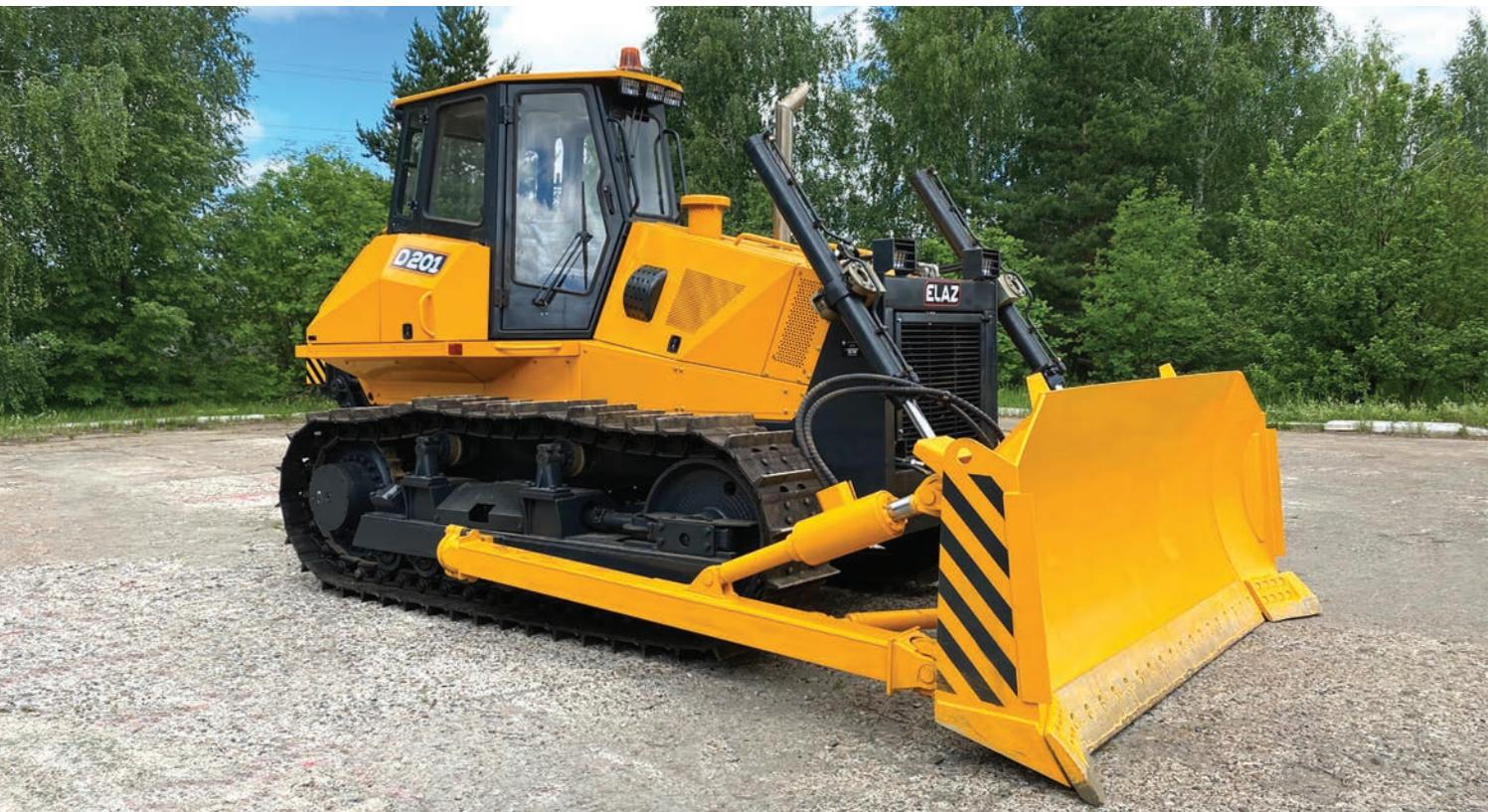
Булдозер D20 предназначен для выполнения широкого комплекса землеройных работ в строительстве, мелиорации, в горнорудной, нефтяной, газовой и других отраслях промышленности на грунтах I-V категории, в том числе на мерзлых и разборно-скальных грунтах, при температурах окружающего воздуха от -50 °С до +45 °С
