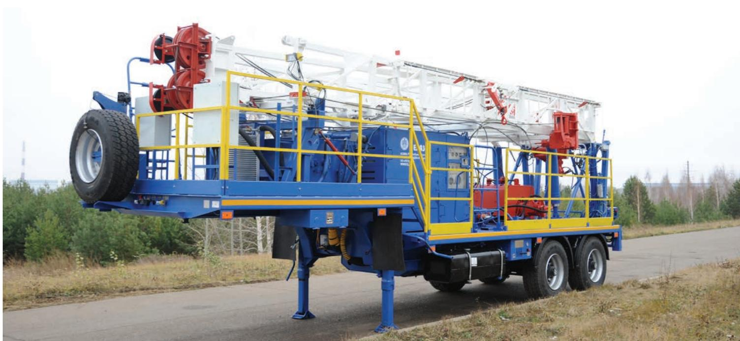
Агрегат подъемный для ремонта наклонных скважин АПРС-18, предназначен для проведения текущего ремонта скважин.
