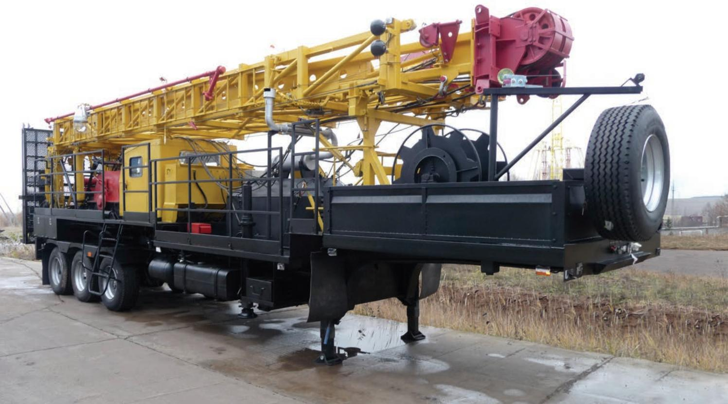
Агрегат предназначен для освоения, капитального и подземного ремонта нефтяных и газовых скважин в макроклиматических районах с умеренным климатом при температуре окружающего воздуха от  $-45^{\circ}\text{C}$  до  $+40^{\circ}\text{C}$ .
