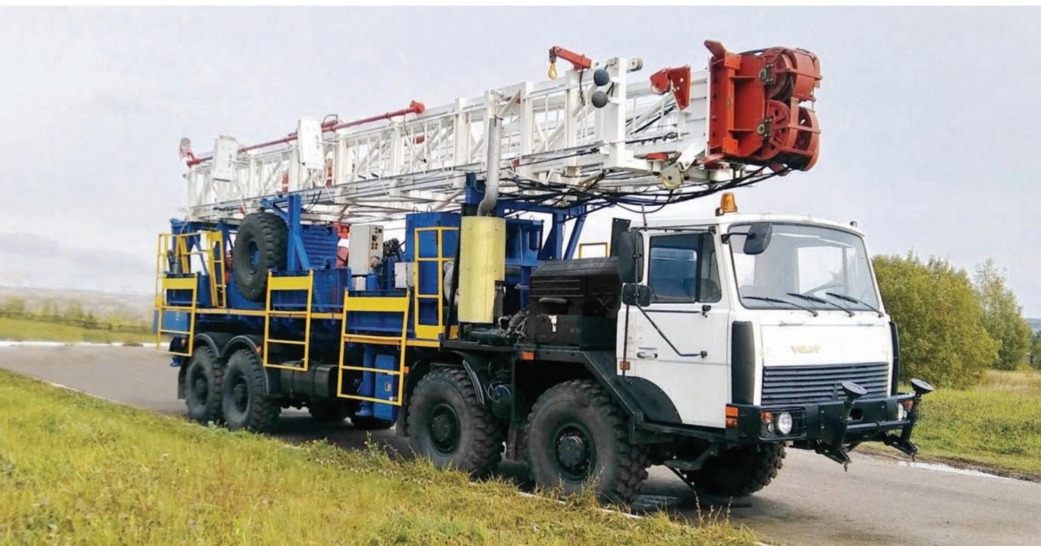
Агрегат предназначен для капитального ремонта и освоения нефтяных и газовых скважин в макроклиматических районах с умеренным климатом при температуре окружающего воздуха от  $-45^{\circ}\text{C}$  до  $+40^{\circ}\text{C}$ .
