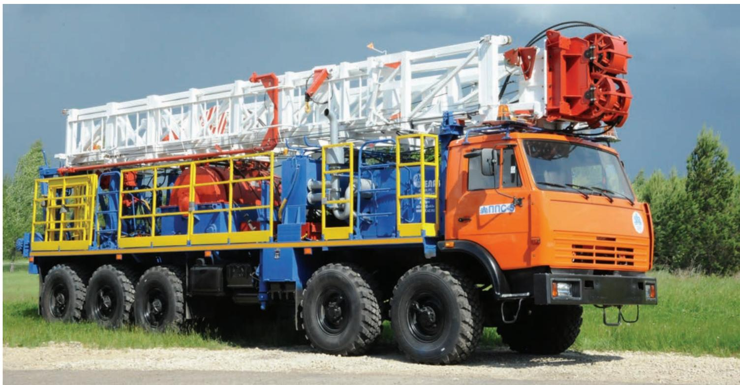
Агрегат предназначен для капитального ремонта и освоения нефтяных и газовых скважин в макроклиматических районах с умеренным климатом при температуре окружающего воздуха от -45° С до +40° С.
