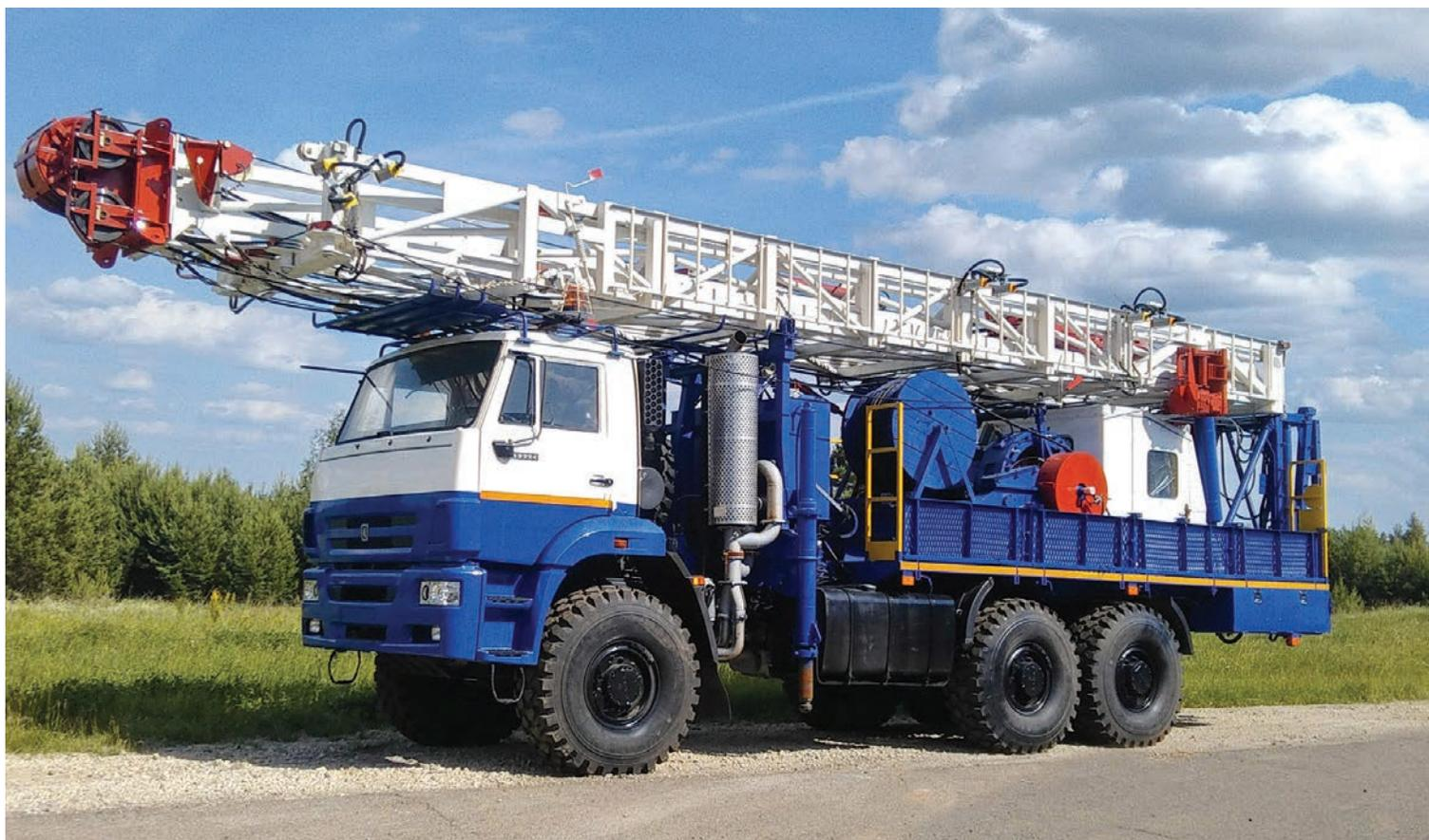
Агрегат предназначен для освоения, капитального и подземного ремонта нефтяных и газовых скважин в макроклиматических районах с умеренным климатом при температуре окружающего воздуха от -45° С до +40° С.
