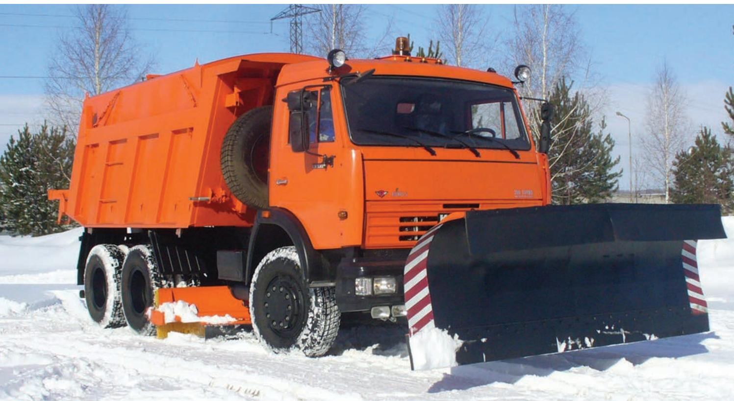
Универсальная дорожная машина на базе автомобиля КАМАЗ предназначена для круглогодичного обслуживания автомобильных дорог:
