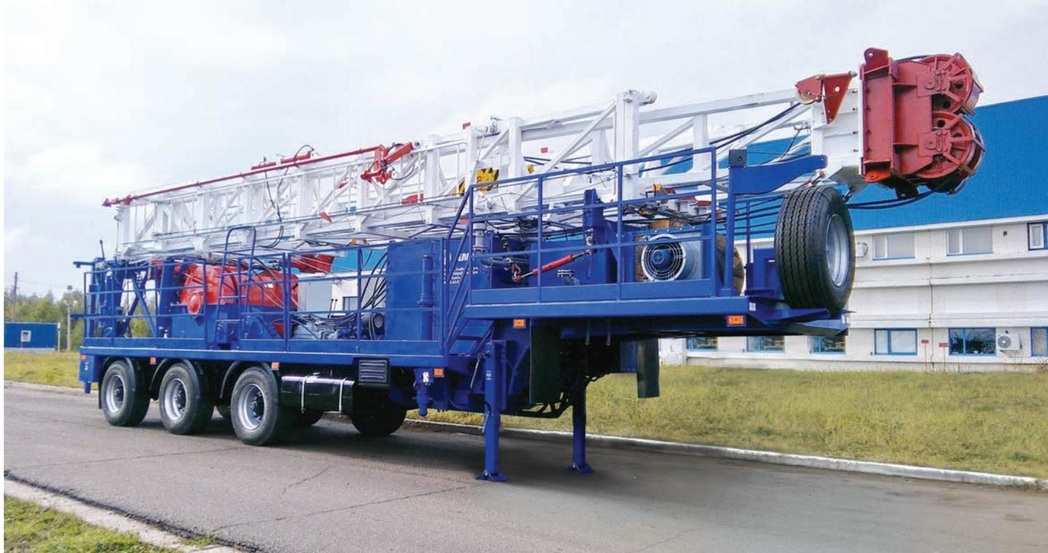
Агрегат предназначен для ремонта, освоения и бурения нефтяных и газовых скважин в макроклиматических районах с умеренным климатом при температуре окружающего воздуха от  $-45^{\circ}\text{C}$  до  $+40^{\circ}\text{C}$ .
