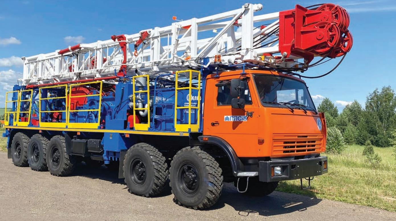
Предназначена для бурения ротором и забойными двигателями скважин глубиной 2500м (при массе колонны 24 кг/м), капитальных ремонтов, освоения и восстановления нефтяных и газовых скважин, глубиной до 5000 м. (НКТ 14кг/м) в макроклиматических районах с умеренным климатом при температуре окружающего воздуха от -45° С до +40° С.
