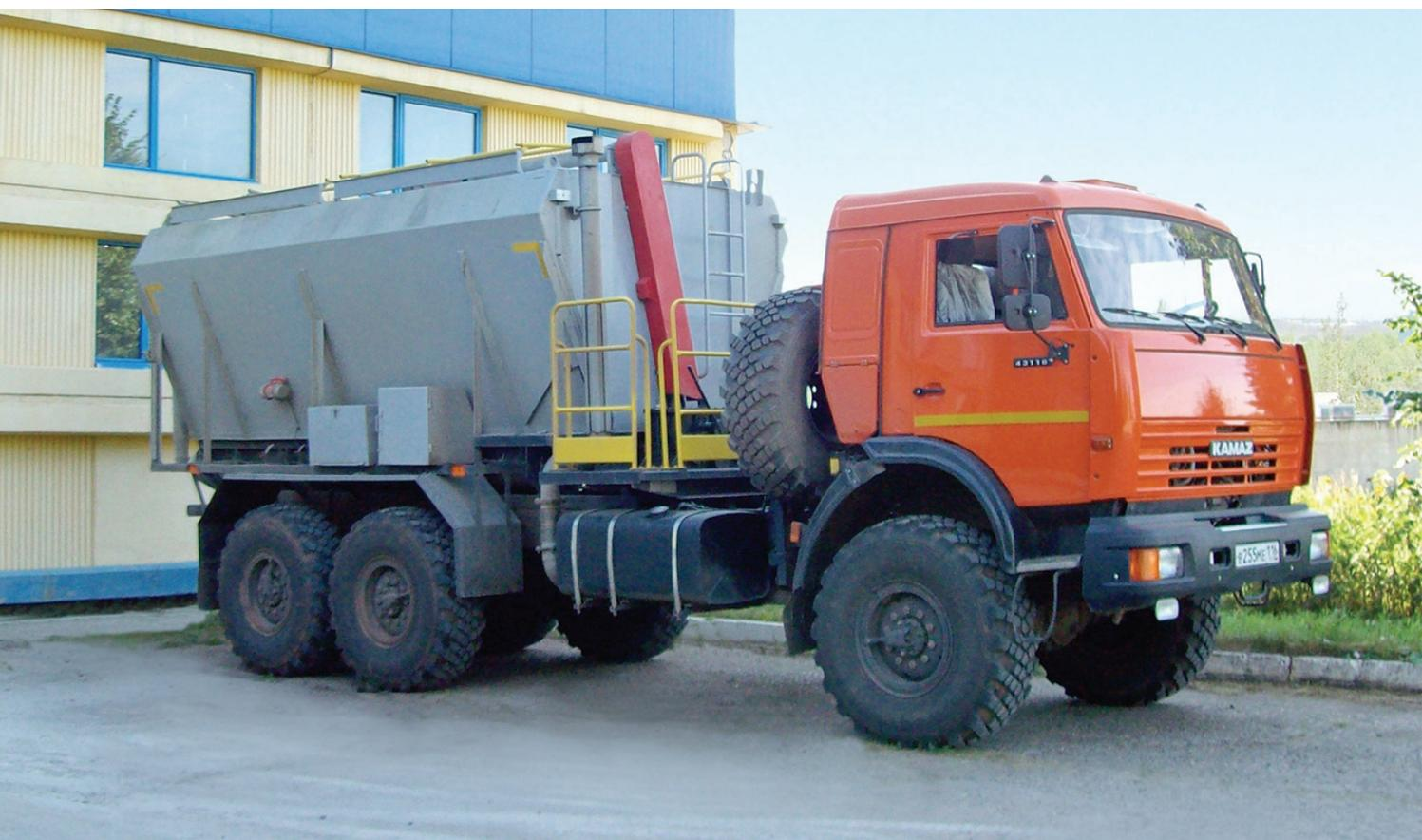
Предназначена для транспортирования сухих порошкообразных материалов (цемент, тампонажные смеси и др.), для механической регулируемой подачи этих материалов винтовыми конвейерами (шнеками) и приготовления тампонажных растворов при цементировании нефтяных и газовых скважин.
