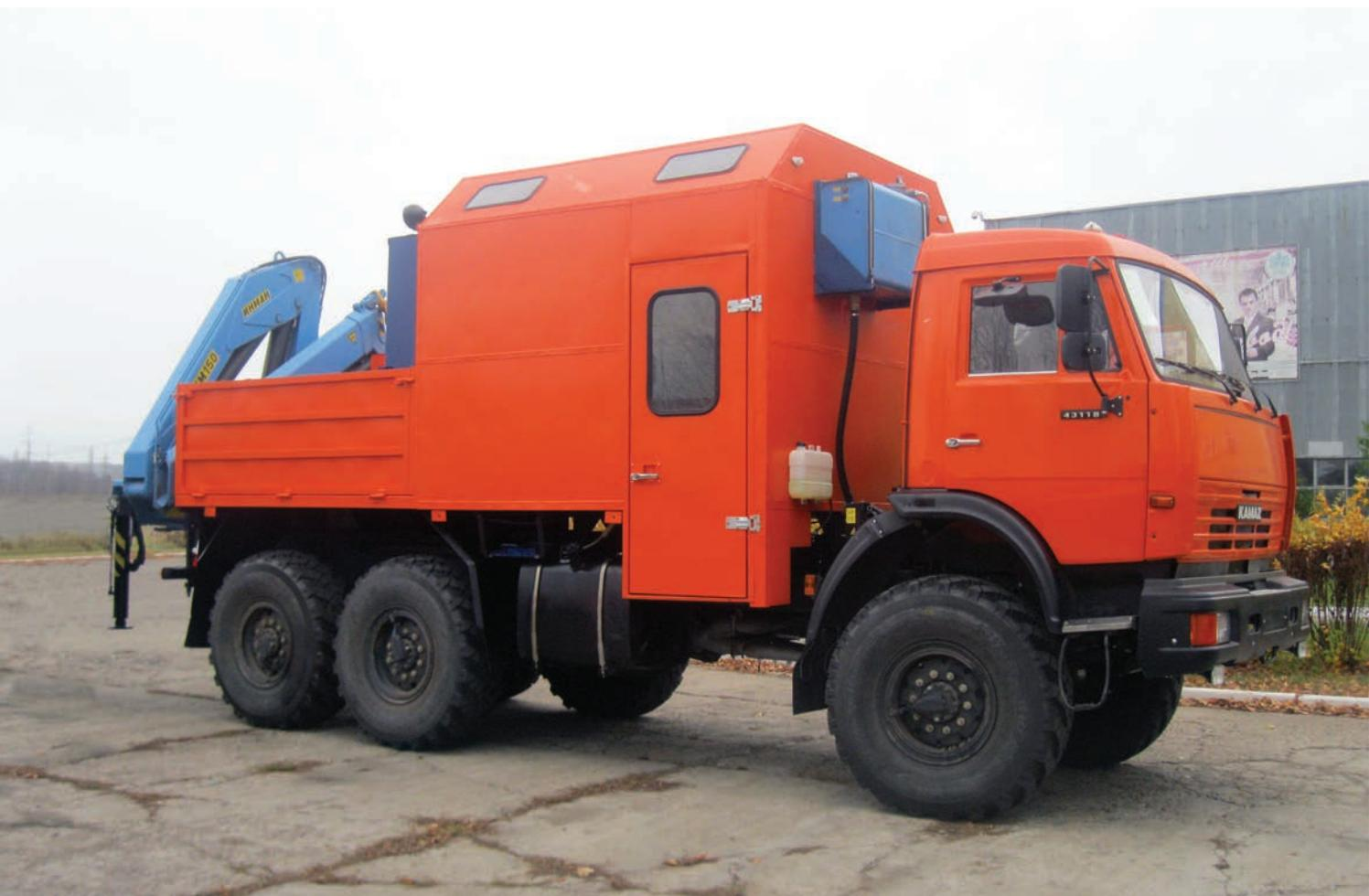
Позволяет производить сварочные, газорезательные, монтажные, монтажно-демонтажные, слесарные работы, покраску оборудования и сооружений; при наличии быстросъемной люльки окраску и ремонт оборудования до 12 м; транспортировку различного оборудования, перевозку дежурной бригады в количестве до 5 человек.
