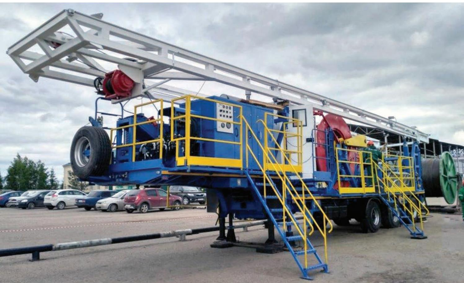
Установка предназначена для проведения текущего ремонта скважин оборудованных штанговыми вставными насосами с целью замены глубинно-насосного оборудования (ГНО), проведения обработок призабойной зоны и ствола скважины, промывки колонны НКТ, освоение скважин и др. с использованием безмуфтовых длинномерных труб (БДТ).
