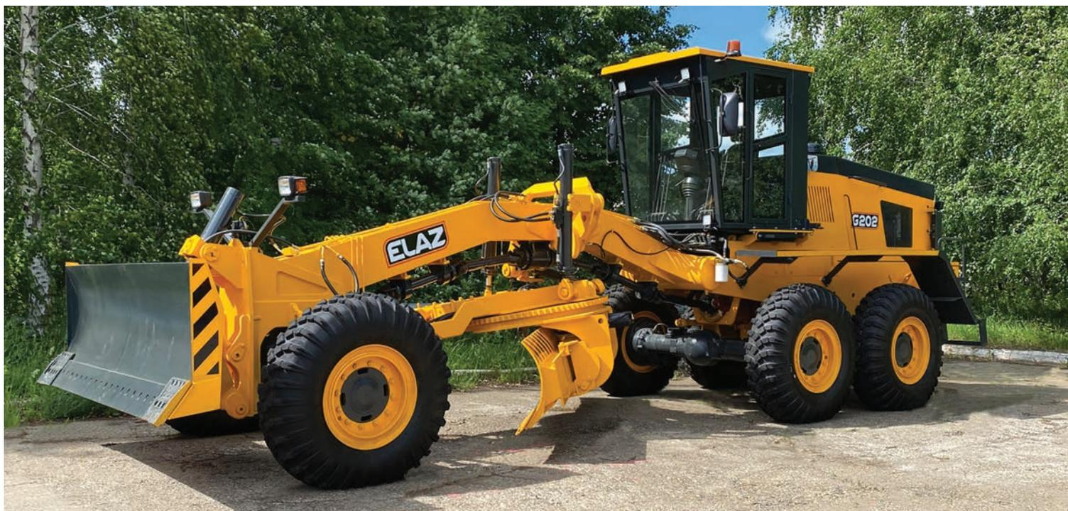
Автогрейдер предназначен для выполнения работ в строительстве, ремонте, содержании дорог и аэродромов. Одним из основных видов выполнения земляных работ является профилирование и планировка поверхности земляного полотна, устройство дренажной системы. Земляные сооружения подобного профиля осуществляются с помощью грейдерного отвала.
