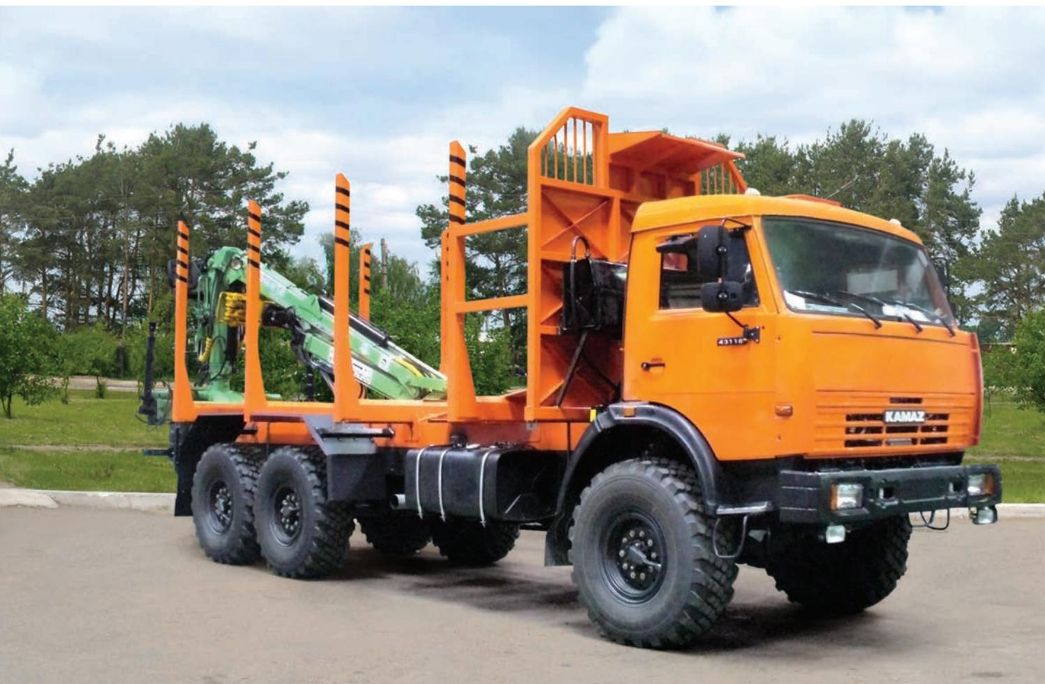
Сортиментовоз с крано-манипулятором предназначен для перевозки лесоматериалов от 2 м до 6 м.
