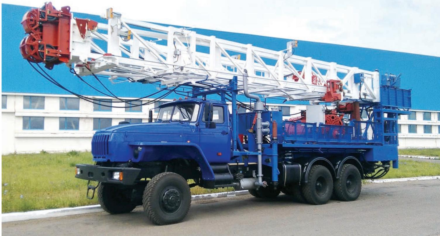
Агрегат предназначен для капитального ремонта и освоения нефтяных и газовых скважин в макроклиматических районах с умеренным климатом при температуре окружающего воздуха от -45° С до +40° С.
